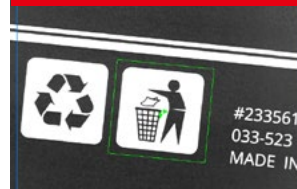
L'éclairage par la LED rouge, mettant en évidence le motif, est utilisé pour réaliser une correction de la position.
